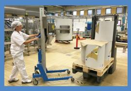
Squeeze&Turn ist eine gern verwendete Ausstattung bei der Handhabung von großen Rollen in der Produktion. An einen Lift&Drive montiert ist sie dem Bediener die Kraft und Kontrolle für sicheres und effizientes Arbeiten.
