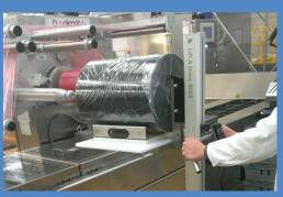
In einer Druckerei werden oft relativ kleine, dafür aber schwere Rollen verschiedenster Materialien gehandhabt. Bei solchen Einsatzgebieten sind sie mit einem Lift&Drive mit Plattform und V-Block bereits einfach und perfekt ausgestattet. Dazu agieren Sie wendig auf kleinstem Raum.
